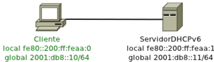
Figura 38: Topologia do exemplo da funcionalidade Autoconfiguração Stateless DHCPv6
