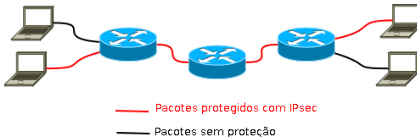
Figura 2: Topologia de Modo Transporte entre dois roteadores
