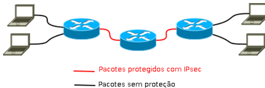
Figura 3: Topologia de Modo Túnel entre as redes 2001:db8:baba:: e 2001:db8:bebe::
