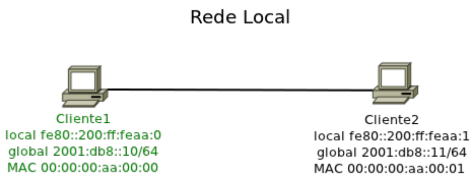
Figura 16: Topologia do exemplo da funcionalidade Resolução de Endereços
