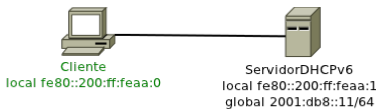
Figura 36: Topologia do exemplo da funcionalidade Autoconfiguração Stateful DHCPv6
